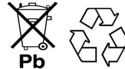
De plus, conformément à la norme IEC 60095-1, les batteries au plomb doivent être étiquetées des pictogrammes de sécurité décrits ci-dessous.
